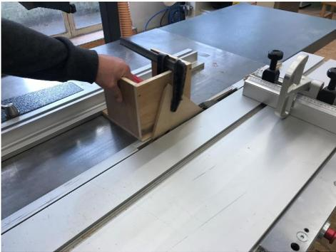
Da der Sägeblattwinkel **nur** bei der 3- seitigen Pyramide immer unter  $45^\circ$  liegt, können die beiden schräg verlaufenden Dreiecksseiten nicht wie sonst mit dem Duplexanschlag, sondern müssen hier hochkant am geneigten Sägeblatt vorbeigeführt werden
